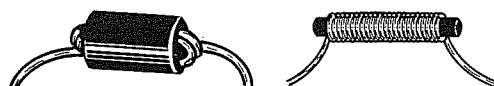
Fig.11 L'impedenza JAF1 di blocco per la RF può essere una VK.200 o a bastoncino.
