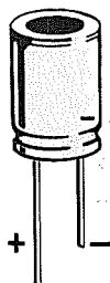
Fig.2 Se sull'involucro di un condensatore elettrolitico non è riportato il segno + in corrispondenza del terminale "positivo", questo lo potrete comunque riconoscere subito perchè più lungo dell'opposto terminale negativo.
