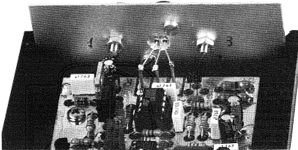
Fig.23 Per saldare i tre terminali del diodo Laser sulle piste 1-2-3 presenti sul circuito stampato, dovrete ripiegarli leggermente, oppure saldarli su tre corti spezzi di filo di rame che avrete saldato in precedenza sulle piste dello stampato.
